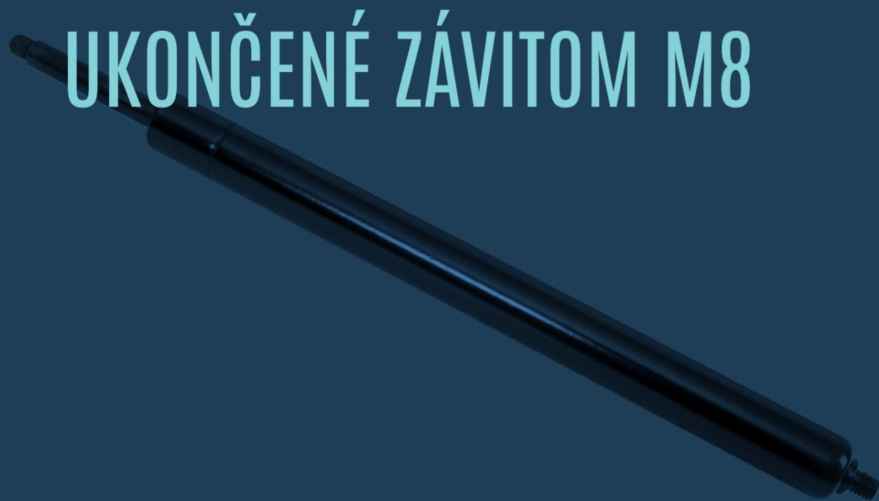
Ťažné plynové vzpery ponúkame v siedmych rôznych dĺžkových vyhotoveniach, ktoré tlakujeme podľa požiadaviek zákazníka v rozmedzí 100N - 1200N. Piestna tyč je vyrobená z ocele C35 a telo valca vyrobené z ocele ST34 2-BK.
